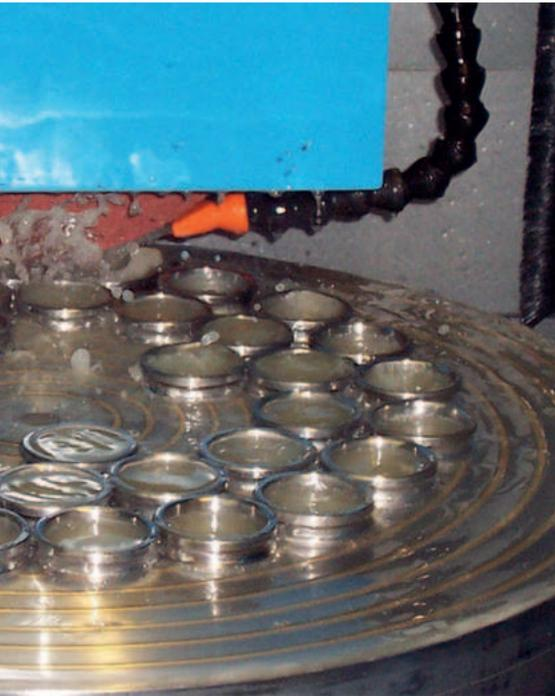
Die Plan- und Stufenbearbeitung flacher rotationssymmetrischer Werkstücke ist in vielen Fällen einfacher als mit einer klassischen Rundschleifmaschine. Insbesondere schwere Werkstücke lassen sich einfach auf den Arbeitstisch laden und bequem ausrichten. Serienteile lassen sich vielfach wirtschaftlicher als mit einer klassischen Flachsleifmaschine bearbeiten, da die Beschleunigung an den Umkehrpunkten entfällt.
