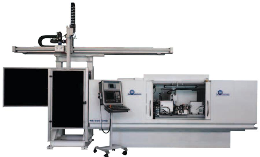
Maschinen, die für die Serienproduktion ausgelegt werden, lassen sich mit einem Ladeportal und einer In-Prozess-Messsteuerung ausrüsten.
