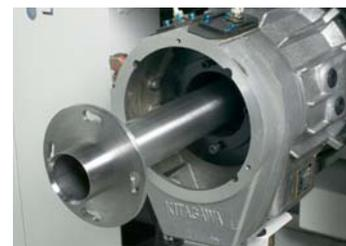
Für jede Drehmaschine können Spindeleinsatzrohre geliefert werden
