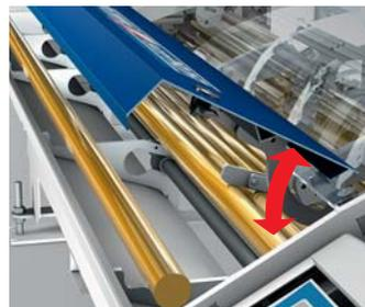
Die speziell konstruierte Ladeklappe ermöglicht das Nachladen der Werkstoffstangen ohne Maschinenstopp
