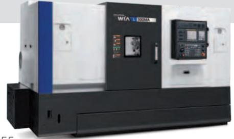
**Ausstattung:** Hydr. Dreibackendrehfutter 305 mm, Werkzeug-Erstausstattung (4 AGW, 8 Halter), Revolver mit AGW und C-Achse, manuelles elektr. Handrad, innere Kühlung 20 bar, Werkzeugvermessung, programmierbarer Reitstock, Teileabholvorrichtung, Späneförderer (Scharnierband)
