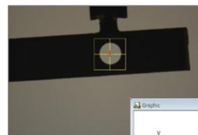
Ein falsch ausgerichtetes Muster wird automatisch mithilfe der intelligenten Suchfunktion erkannt
