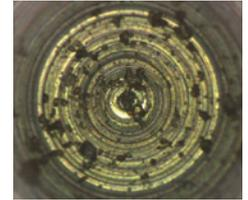
Sogar der Grund eines sehr kleinen Bohrlochs kann scharf abgebildet werden.
