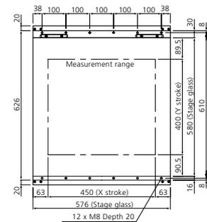
Geeignet für Objekte mittlerer Größe (250 x 200 x 200 mm – 450 x 400 x 200 mm) und die Messung von mehreren Kleinteilen gleichzeitig. Sehr gutes Preis-Leistungs-Verhältnis, da dieses Modell in derselben robusten Gusseisenkonstruktion und Direktlagerung ausgeführt ist wie das Premiummodell der NEXIV VMZ-R Serie.
