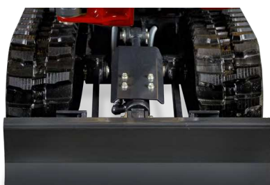
Eingefahrener Unterwagen 680 mm - Einfaches Manövrieren
