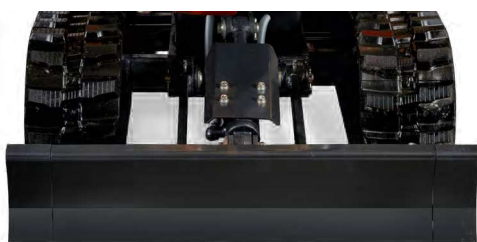
Ausgefahrener Unterwagen 840 mm - Mehr Standfestigkeit
