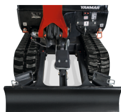
Eingefahrener Unterwagen: 980 mm
