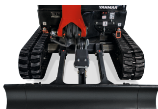
Ausgefahrener Unterwagen: 1170 mm
