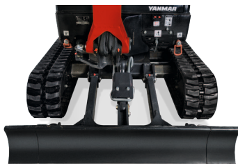
Ausgefahrener Unterwagen : 1 320 mm
