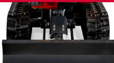
← → Eingefahrenes Fahrwerk: 1 000 mm
