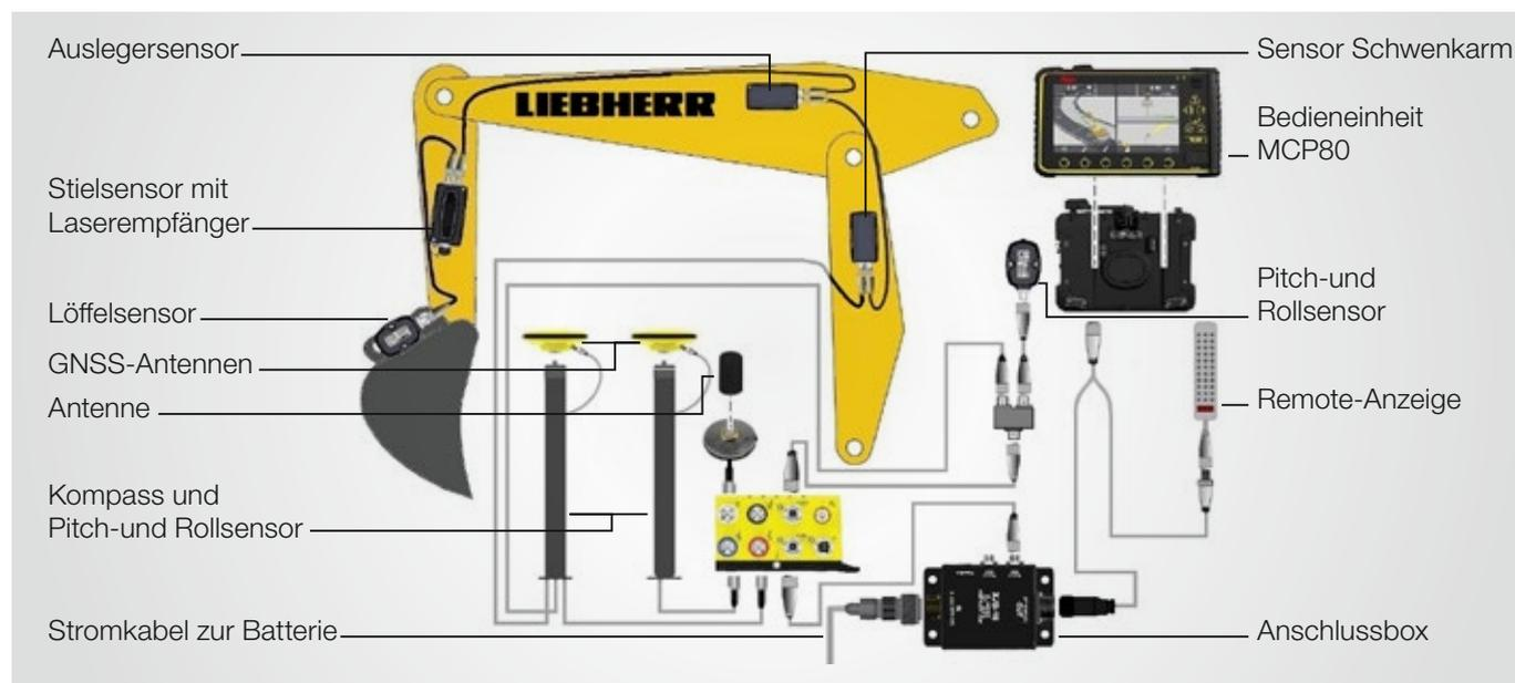
Darstellung des Systems 3D iCON IX3 passiv Leica designed for Liebherr an einem Verstellausleger
