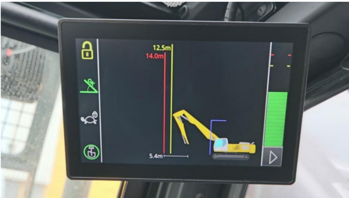
Diese ergonomisch im Blickfeld des Fahrers angebrachte aktive Sicherheitskomponente informiert in Echtzeit über die Werkzeugposition und die Standneigung der Maschine. Bei Überschreiten einer kritischen Messgröße löst das LDC
