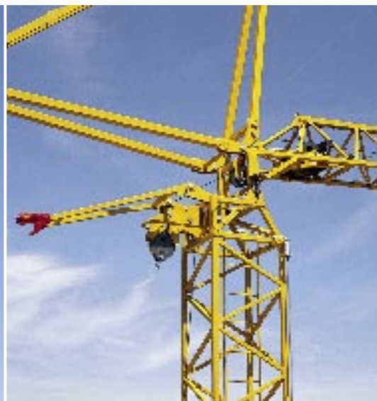
Gleichmäßige Verteilung der Kräfte im Turm durch die mittige Ausleger-Anlenkung.
