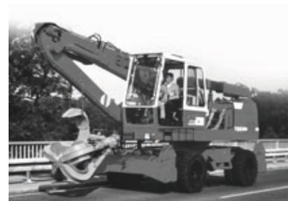
Erste hydraulisch verstellbare Kabinenerhöhung
