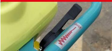
Optimierter Multifunktionsgashebel, der die Bedienung erleichtert und die schonende Behandlung der Maschine und deren lange Lebensdauer sicherstellt.
