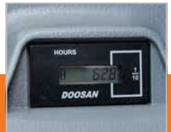
Betriebsstundenzähler (vom Boden aus ablesbar)
