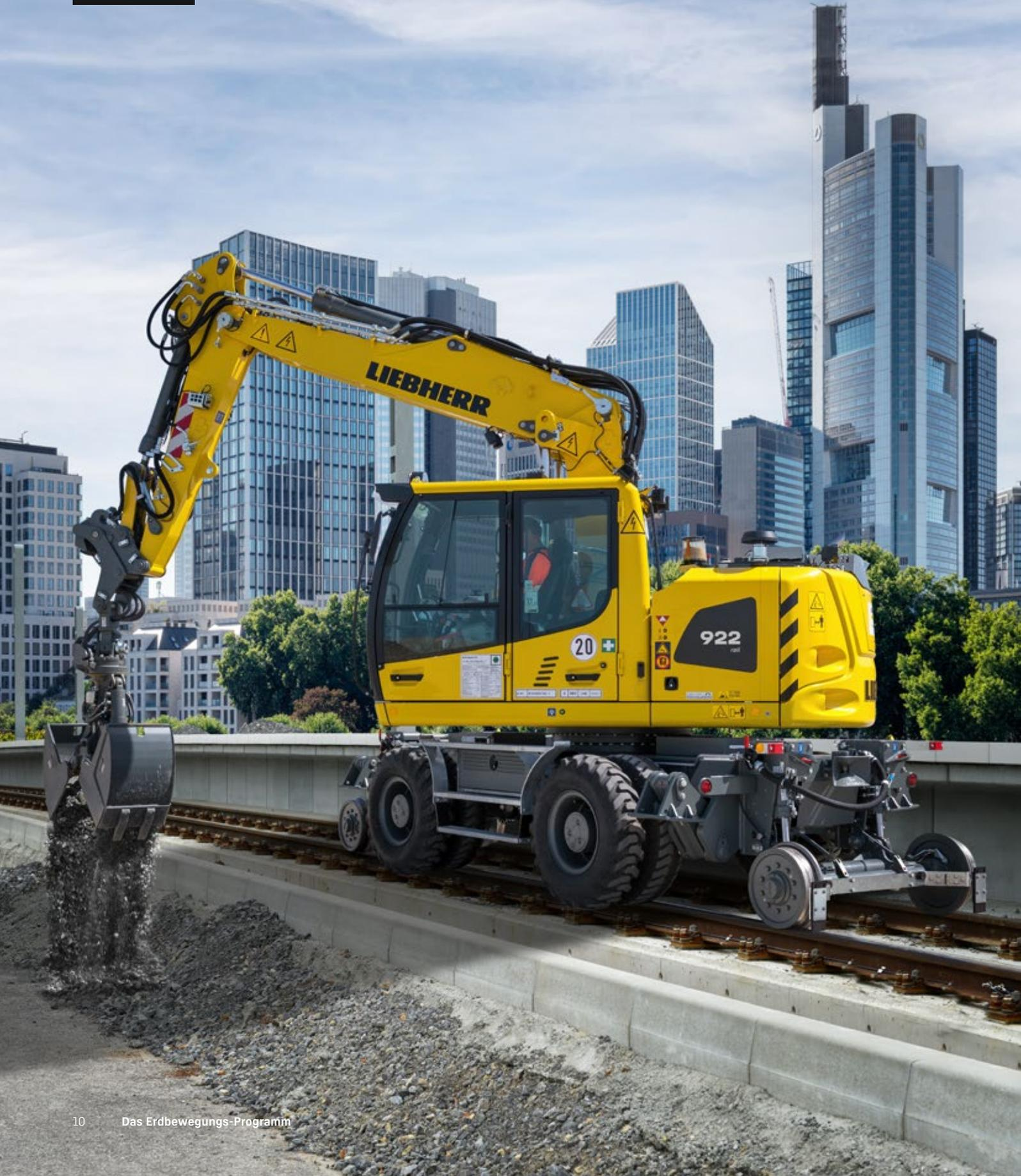
Liebherr entwickelt seit 1967 Zweiwegebagger und ist als OEM-Hersteller der Weltmarktführer in diesem Bereich. Sie werden an länderspezifische Vorgaben angepasst, sodass sie den örtlichen Gegebenheiten und Sicherheitsbestimmungen entsprechen. Gleisbagger können wahlweise auf der Straße oder der Schiene eingesetzt werden.
