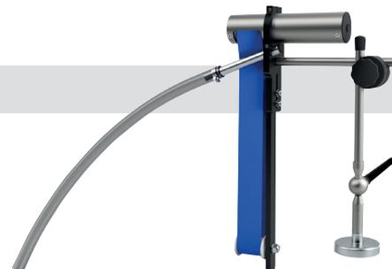
**Anwendung:** Beim Bandskimmer werden die aufschwimmenden Fremdöle (der Ölfilm sollte geschlossen sein) mittels eines Spezialbandes abgetragen. Der Vorteil gegenüber dem Scheibenskimmer liegt bei dem geringeren Platzbedarf und einer höheren Eintauchtiefe. Je nach Ausführung sind bis zu 800 mm möglich.
