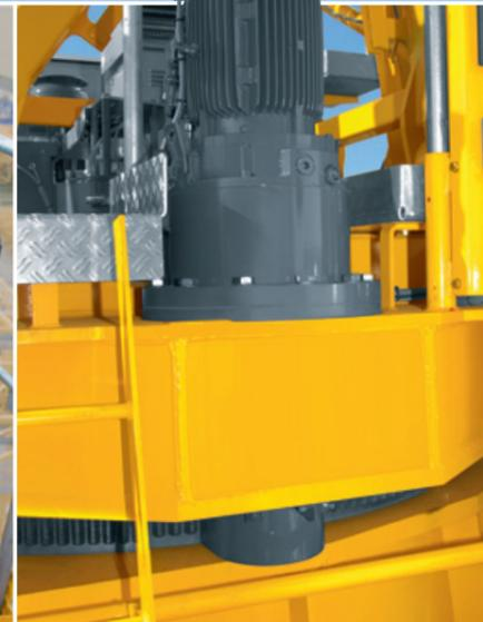
Alle Antriebe sind bei den kleinen und mittleren EC-B-Kranen direkt und sicher vom Kompaktkopf aus zugänglich.
