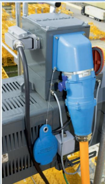
Elektrische Steckverbindung des Hubwerks.
