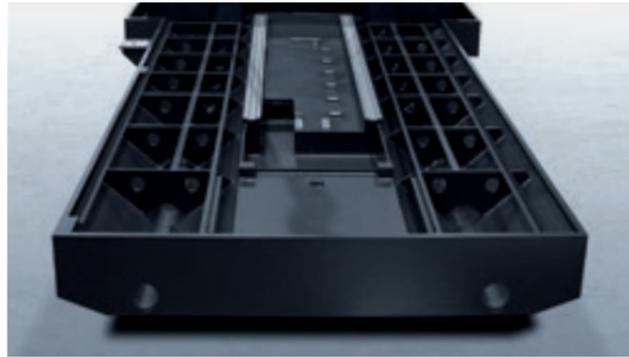
1\_ Hohe Stabilität und Steifigkeit der Maschinenstruktur. Großzügige Führungsabstände garantieren hohe Genauigkeit bei anspruchsvoller Zerspanung. Maschinenbett optimiert für die Späneentsorgung bei Fräs- und Drehbearbeitung.
