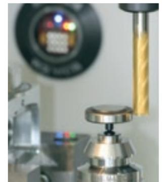
Kompaktes Werkzeugkontroll-System über Berührung zum Aufstellen auf dem Arbeitstisch.
