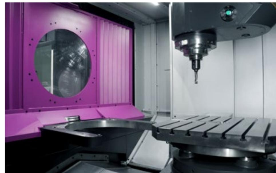
Die nächste Werkstückspannung kann während laufendem Bearbeitungsprozess vorbereitet werden. Optional kann das Werkstück in Ladeposition manuell um 4 x 90° geschwenkt werden.
