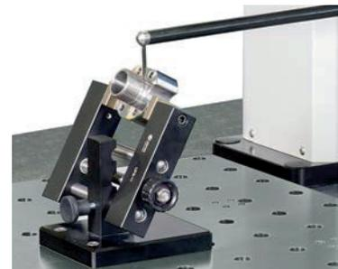
Steckbare Führungsanschlüsse und eine breite Palette an standardisierten Spannvorrichtungen sowie Werkstückaufnahmen erlauben die flexible Positionierung Ihres Prüflings.
