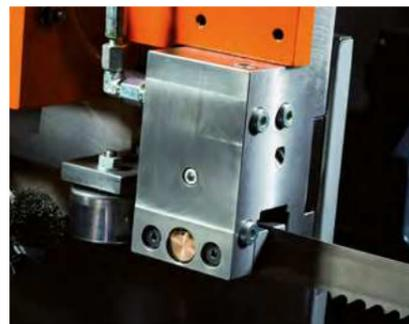
Hydraulisch vorgespannte Bandführung
