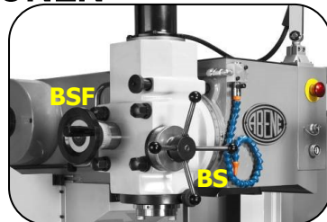
SPINDELKOPFTYPEN BS: Bohrspindel, Pinole mit 75 mm Hub, Bedienung über Handhebel BSF: Handrad für Feinvorschub 3 mm/U.
