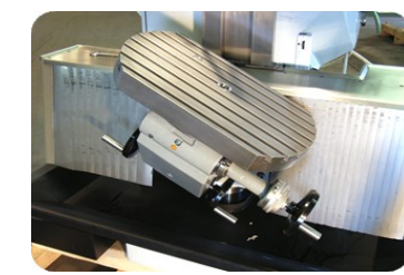
DREH-UND SCHWENKTISCH Dieser kann als B- (links) und C-Achse (rechts) verwendet werden
