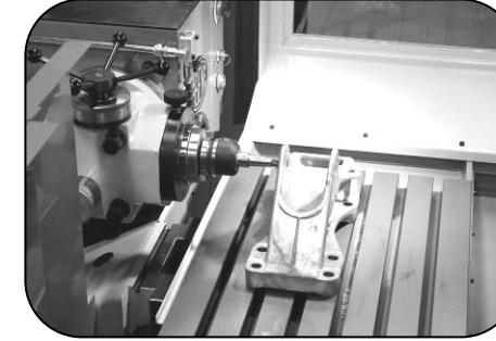
HORIZONTALE POSITION Der Spindelkopf ist mit einem Präzisions-Indexierbolzen gesichert. Spindelstock und Gegenhalter in unterer Position. Spindel zu Tisch: 65-540 mm
