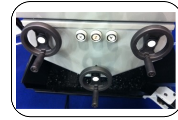
ELEKTRONISCHE HANDRÄDER 3 Handräder für die X-, Y- und Z-Achse elektronisch gesteuert (vorne am Tisch montiert). Diese Option ersetzt das elektr. Handrad HR 410
