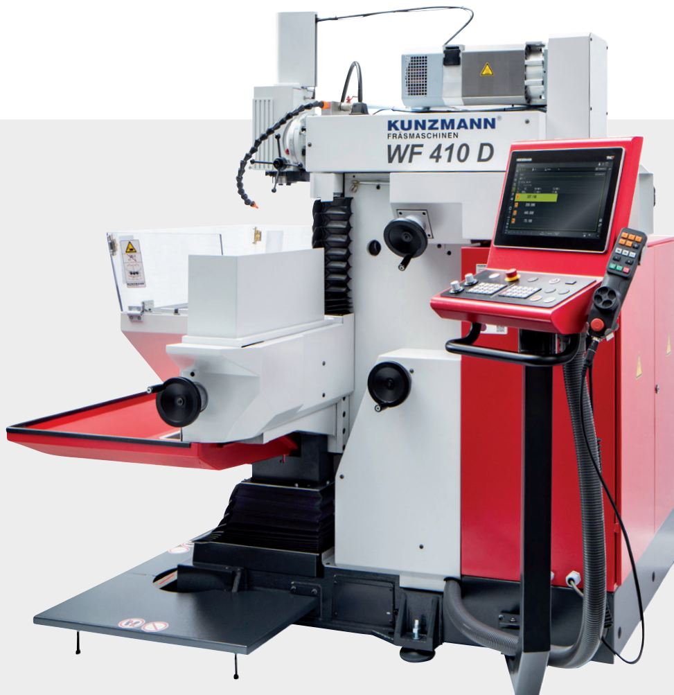
↑ WF 410 D Seitenansicht mit manuellen Handrädern in allen Achsen
