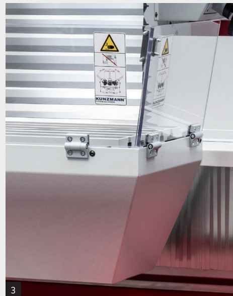
Manuelles Handrad X-Achse (1), Ölauffangwanne und Kühlmittelbehälter (2), Spritzschutz (3)
