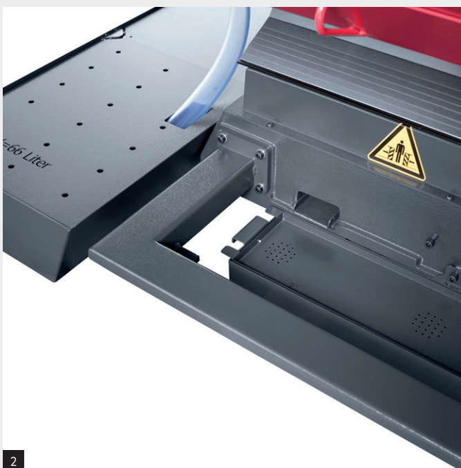
Manuelles Handrad X-Achse (1), Ölauffangwanne und Kühlmittelbehälter (2), Spritzschutz (3)
