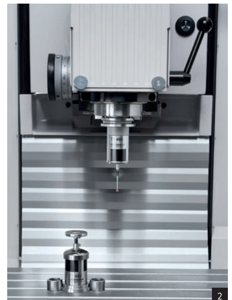
CNC-Teilapparat (1), Tastkopfsystem und automatische Werkzeugvermessung (2)
