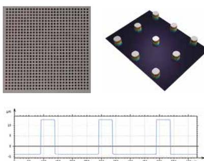
Teststruktur (TEG) eines Halbleiterbauteils
