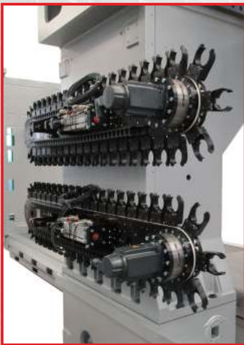
A catena con traslazione fissato lateralmente al portale della macchina.
