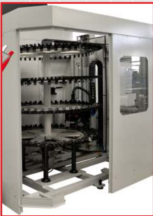
A ruote sovrapposte con braccio di scambio installato lateralmente alla macchina.
