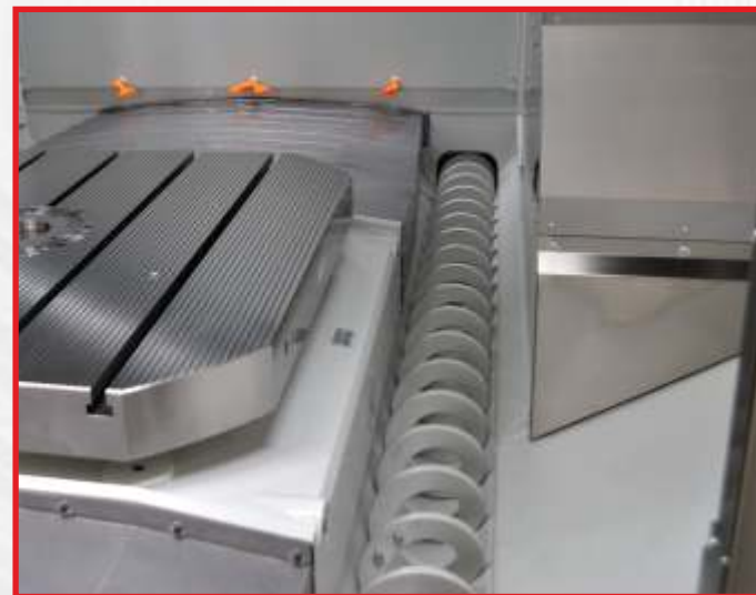
Sistema di evacuazione truciolo e lavaggio. Chip evacuation system and washing system. Spanabfuhr- und Waschsystem. Système d'évacuation et de lavage des copeaux.
