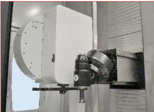
**Magazzino a tamburo con braccio di scambio fissato lateralmente al basamento della macchina.**
