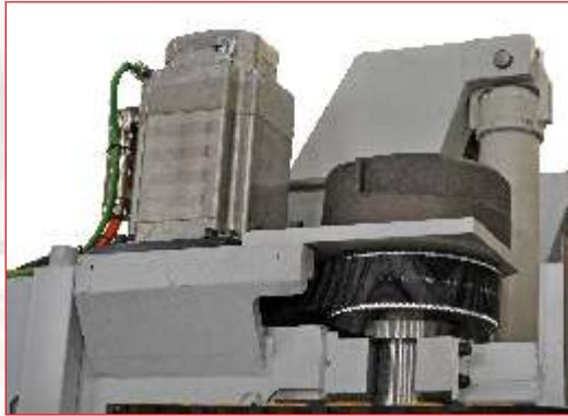
**Movimento longitudinale ottenuto tramite doppio motore (Dual Drive) con precarico elettronico e accoppiamento diretto ad una cremagliera di precisione**
