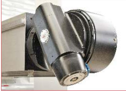
**Testa a 2 assi continui di lavoro azionata da motori torque**. Completamente raffreddata con campo di velocità del motomandrino fino a 22000 g/1'
