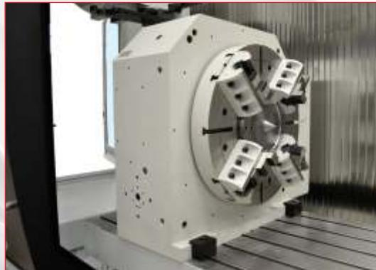
**Divisore girevole in continua comandato dal CN ed azionato tramite motore torque.**
