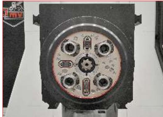
**Sistema di sbloccaggio automatico teste integrato nello slittone con pinze di trazione a funzionamento idromeccanico e corone hirth per assicurare ripetibilità di posizionamento e massima rigidità, completo di connessioni elettriche ed idrauliche. Il tutto viene gestito da CN con funzioni ausiliarie.**
