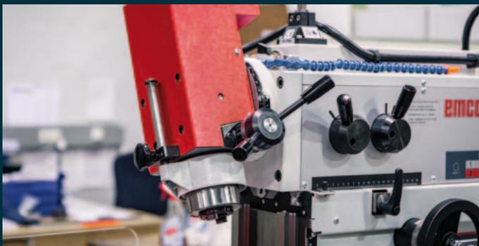
**Vertikalfräskopf.** Vertikaler Fräskopf mit DIN 2080 SK 30 und klemmbarem 45 mm Pinolenhub. Der Vertikalfräskopf ist um +/- 90° schwenkbar.
