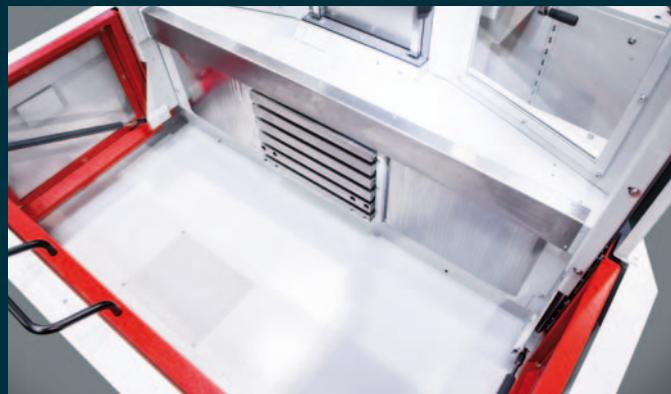
**Versenkbarer Arbeitsschutz** mit senkrechter Aufspanfläche.
