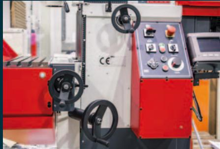
**Sicherheitshandräder (X/Y).** Ergonomisch angeordnete Handräder garantieren leichte und sichere Handhabung in allen 3 Achsen.
