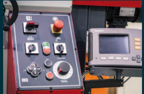
**Bedienpult.** Das Bedienpult ist mit einer übersichtlichen Tastatur und einer ausschwenkbaren Positionsanzeige für eine einfache Bedienung ausgestattet.
