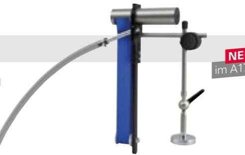
**Anwendung:** Beim Bandkimmer werden die aufschwimmenden Fremdöle (der Ölfilm sollte geschlossen sein) mittels eines Spezialbandes abgetragen. Der Vorteil gegenüber dem Scheibenskimmer liegt bei dem geringeren Platzbedarf und einer höheren Eintauchtiefe. Je nach Ausführung sind bis zu 800 mm möglich.
