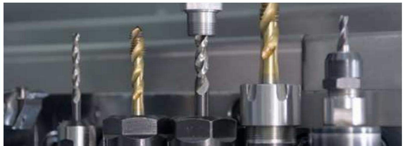
**GÜHRING** HSS DIN 338 Typ N  $\text{M}_118^\circ$
