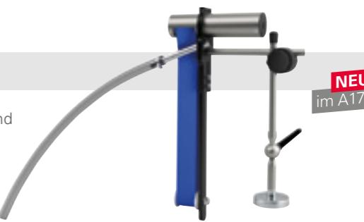
**Anwendung:** Beim Bandskimmer werden die aufschwimmenden Fremdöle (der Ölfilm sollte geschlossen sein) mittels eines Spezialbandes abgetragen. Der Vorteil gegenüber dem Scheibenskimmer liegt bei dem geringeren Platzbedarf und einer höheren Eintauchtiefe. Je nach Ausführung sind bis zu 800 mm möglich.
