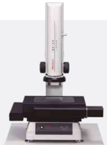
QI-C2017D mit motorischem XY-Messtisch
