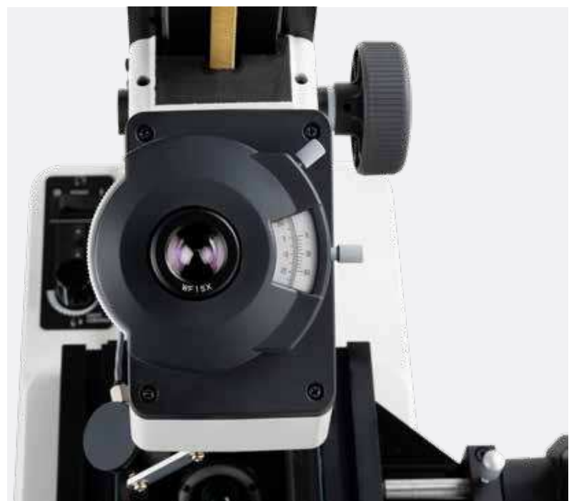
Eine am äußeren Rand des Okulars angebrachte Nonius-Skala ermöglicht eine einfache Winkelmessung.
