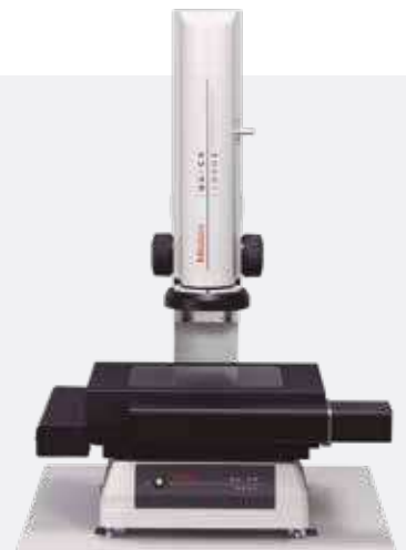
QI-C2017D mit motorischem XY-Messtisch
