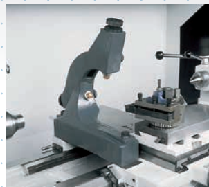
Mitlaufende Lünette mit Gleitbacken Ø 10 – 160 mm
