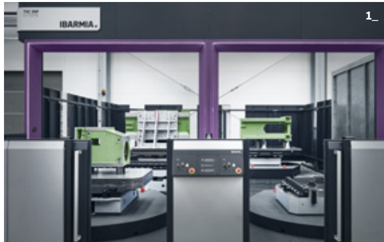
1_ Oben: Palettenpool mit vier Stationen auf einer THC 30 EXTREME (Modell mit einer Drehkapazität von bis zu \varnothing 3000 mm für Teile bis zu h1950 mm und 20 t). Diese Stationen zum Be- und Entladen der Teile während des Betriebs der Maschine (2 und 3) eliminieren die Stillstandszeiten, die durch komplexe Bearbeitungen dieser Art von großvolumigen Teilen verursacht werden (siehe Seite 21).
