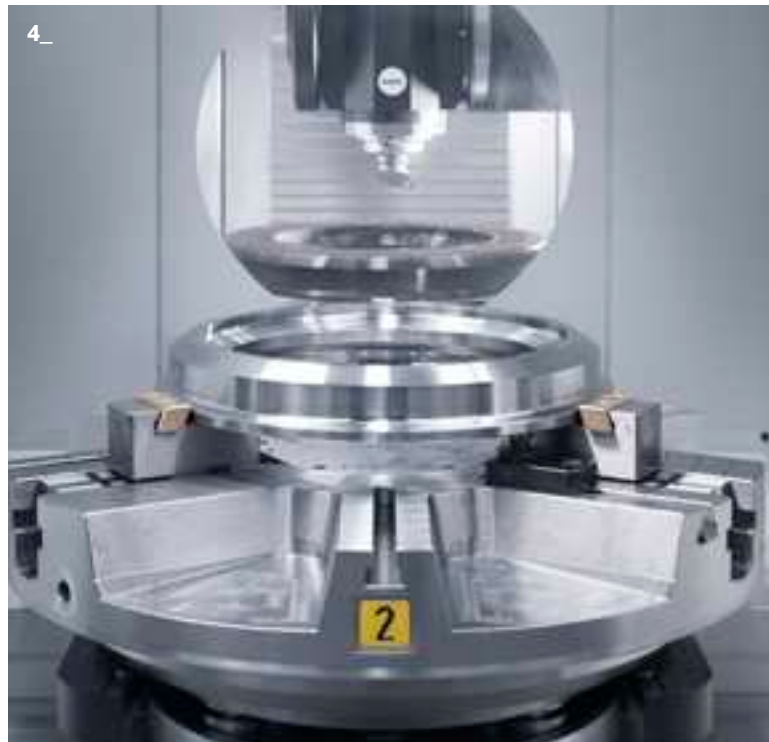
4_ THR 12 MULTIPROCESS ausgestattet mit Wechsel- Drehtisch für die Wartung der Räder von U-Bahn-Zügen. Modelle mit Palettenwechsel- system (siehe Seite 19) steigert die Produktion und die Autonomie der Maschine bei gleichzeitiger Minimierung der Platzbelegung im Werk.
