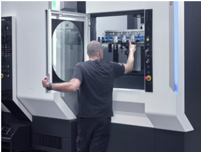
Dieser neue Werkzeugwechsler steigert die Produktivität und Effizienz der Maschine. Er ermöglicht einen sicheren Werkzeugwechsel außerhalb des Arbeitsbereichs, das Beund Entladen des Magazins während des Maschinenbetriebs und gewährleistet einen einfachen sowie ergonomischen Zugang zu allen Wartungselementen.
