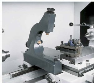
Mitlaufende Lünette mit Gleitbacken Ø 10–160 mm
