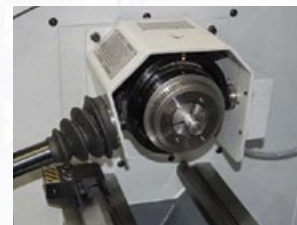
Hebelschnellspannfutter für Druckspannfutter
