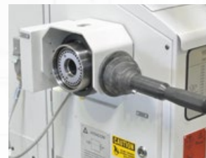
Hebelschnellspann- einrichtung für Zugspannzangen
