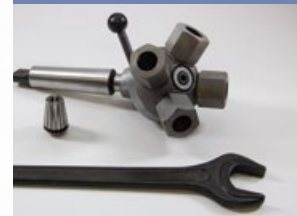
Reitstock-Schrägreivol- verkopf zum Zentrieren, Bohren, Senken und Gewindeschneiden
