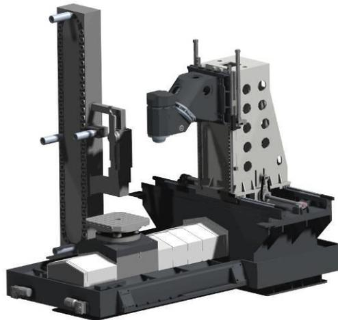
Bewegliche Fahrständerelemente: Säule und Spindelkopf sind aus einer verwindungs- und spannungsfrei geglähten Schweißkonstruktion. Der Tisch sowie der Spindelstock für die Aufnahme der Hauptspindel sind aus Grauguss.
