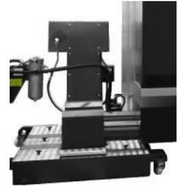
Hinweis: Der Späneauswurf erfolgt an der linken Seite der Maschine wahlweise nach vorne oder hinten (Auswurfrichtung zu bestimmen).
