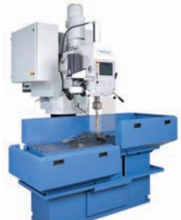
Spritzschutz P. 11.30 vertikal beweglich, 2-teilig, linke Seite im Bild abgesenkt
